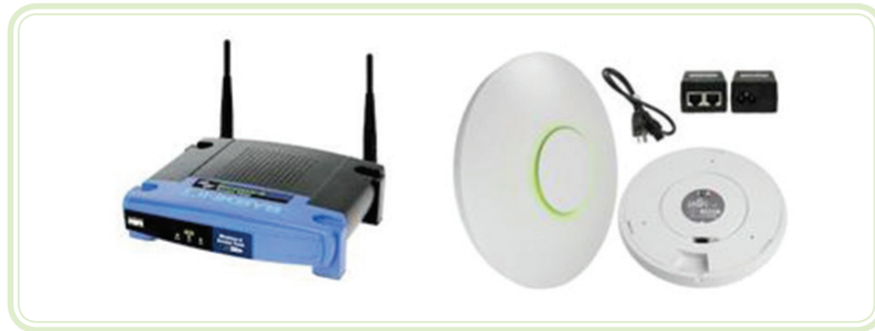
Figura 4.5: Access point de mesa e de teto
